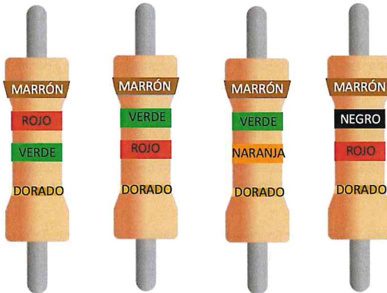
Figura 2. Resistencias que se pueden elegir para el circuito divisor de tensión
